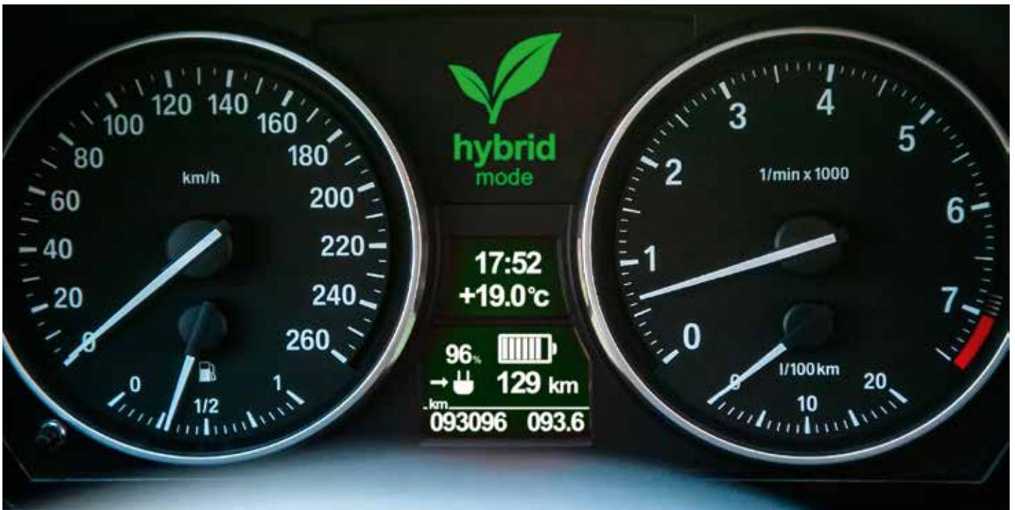
La motorisation hybride combine deux technologies existantes sous la forme thermique ou électrique pour obtenir le meilleur de chacune des technologies : l'autonomie du moteur thermique et l'efficacité de la propulsion électrique propre, silencieuse, simple. La batterie se recharge pendant les phases de décélération en
