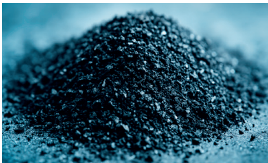
Black mass, poudre issue du recyclage des batteries.
